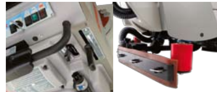
Bürstdruck in drei Stufen regulierbar. Sauglippen vierfach verwendbar und werkzeuglos abnehmbar.
