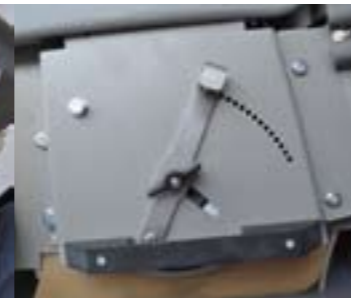
Sweep CS60 AB: Einfache Verstellbarkeit der Bürsthöhe.
