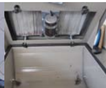
Großer robuster Grobschmutzbehälter mit großem Filter und kräftigem Rüttler.
