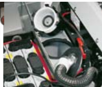
Einfacher Zugang zu den zu wartenden Bauteilen, wie dem Schmutzwasserfilter.
