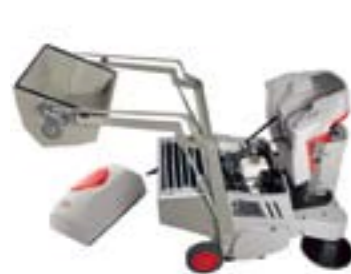
Hydraulische Hochentleerung und Zugang zu Batterie, Motor und Filter bei der Sweep CS 800 AHB.
