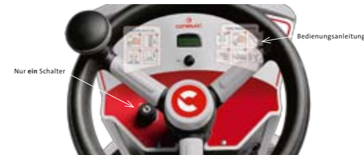
Einfachstes Bedienpult: nur ein Schlüsselschalter. Daneben Hinweise zur Bedienung für den Fahrer. (Innova 60 B)
